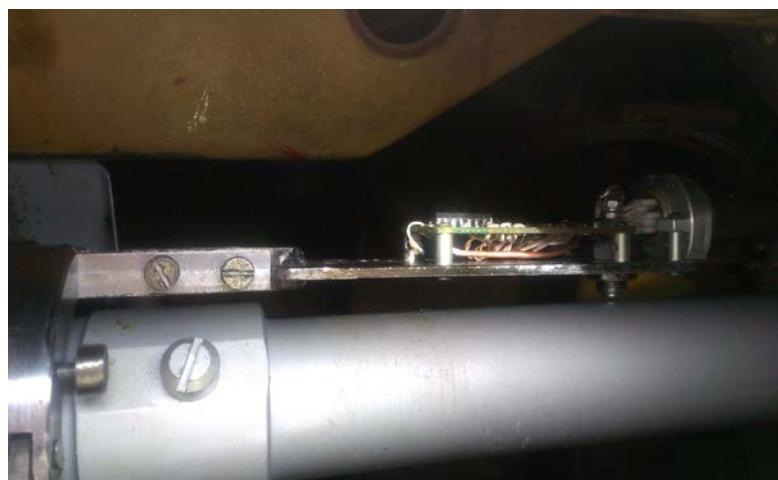
Рис. 2. Фото Установки макета электронного блока для проверки излома валов трансмиссии на вертолете МИ-17
