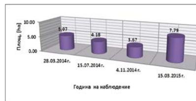
Фиг. 11. Изменение на площта на плаващ тръстиков остров K4
