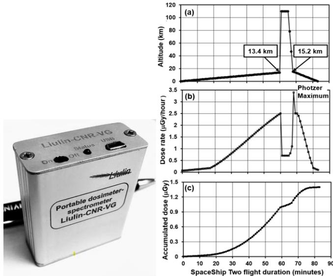
Fig. 5. Liulin-CNR-VG Spectrometer
