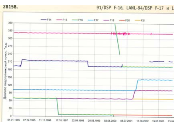
фиг. 3. Еволюция на дължината на подспътниковата точка на функциониращите спътници от типа DSP
