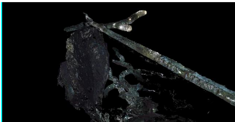
Фиг.3. Участък „Крушев дол“ – 3D модел на хоризонт 550 и свързващата изработка с участък „Петровица“
