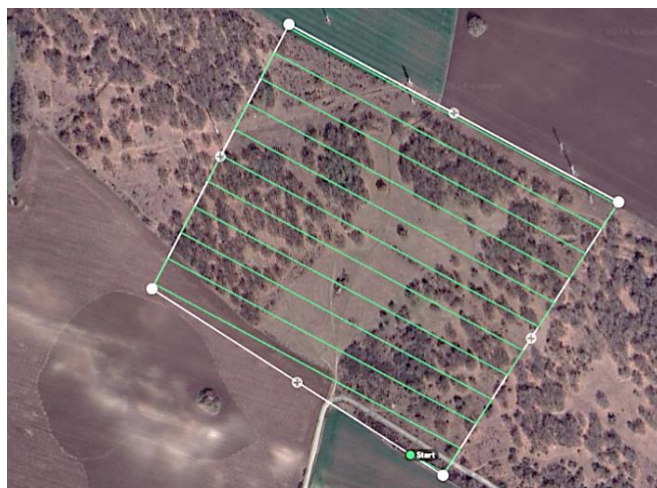
Фиг. 2. Полет на фотограметричен дрон по предварително зададен маршрут с цел аерофотографиране на зона за заемане от артилерийска батарея в района на „Бештепе“ – гр. Шумен.
