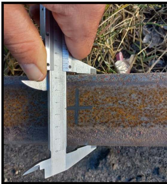
Фиг. 7. Измерване на износена релса с проектна ширина 7.00mm с шублер с къси челюсти. Шублерът показва ширина 6.87 mm като това влияе върху правилното определяне на центъра (оста) на релсите
