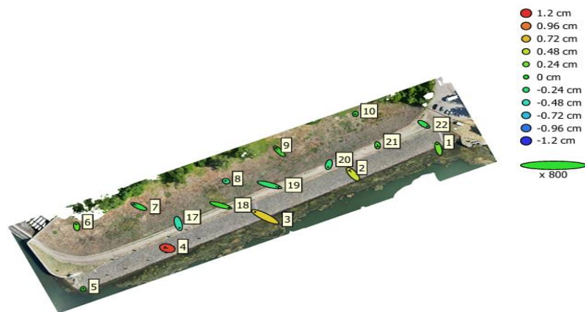
Фиг. 6. Схема с GCP и елипси на грешките
